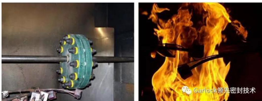
图 1: 安装 VCFS 绝缘组件的法兰(外观)和耐火测试中的法兰
